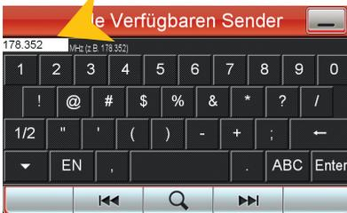
**Frequenzdirekteingabe:** Diese Funktion dient nur zur Prüfung der lokalen Empfangssituation oder zum Testen eines einzelnen Frequenzblockes. Tragen Sie dazu in das weiße Feld die gewünschte Frequenz (nur Zahlen und Punkt) ein und bestätigen Sie die Eingabe durch Tippen auf die Lupe.
