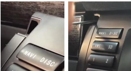
Nehmen Sie die Blenden an den oberen Ecken auf beiden Seiten des Geräts ab, um das Radio zu verschrauben.
