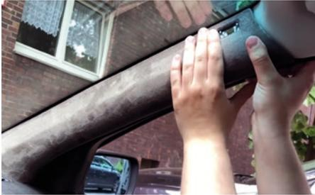
**Befestigen Sie wieder die A-Säulenverkleidung und hebeln Sie vorsichtig die Dichtung darüber.**
