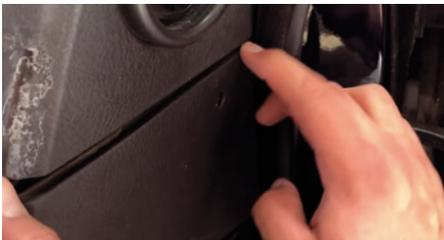
Nutzen Sie die Spalten des Armaturenbretts um das Kabel in Richtung Mittelkonsole zu verlegen.
