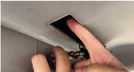
**Entfernen Sie die Beifahrerbeleuchtung der Sonnenblende und ziehen Sie die verlegte GPS-Antenne heraus.**
