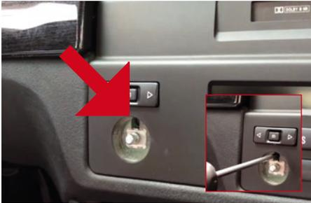
Innerhalb des Knopfes befindet sich oben eine kleine Schraube, welche gelöst werden muss.
