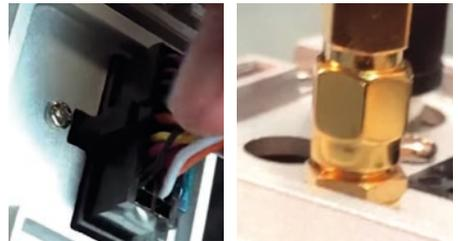
Verbinden Sie GPS-Antenne und die restlichen Kabel mit dem Gerät.
