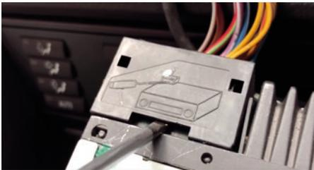
Mithilfe des Schlitzschraubenziehers den Radioadapter abhebeln.
