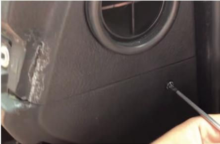
Öffnen Sie die Beifahrertür und entfernen die Schraube des unteren Armaturenbretts.
