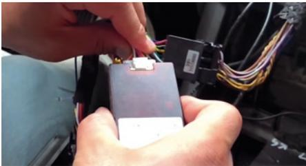
Stecken Sie den CAN-BUS-Decoder an den Adapterstecker.
