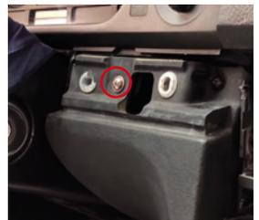
Entfernen Sie die Blenden neben dem Lenkrad und auf der Beifahrerseite. Schrauben Sie nun die darunter liegenden Schrauben heraus.
