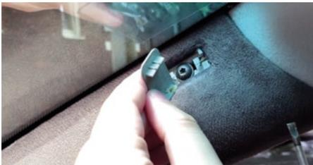
Entfernen Sie die Airbag-Abdeckungen an der A-Säule der Beifahrerseite.
