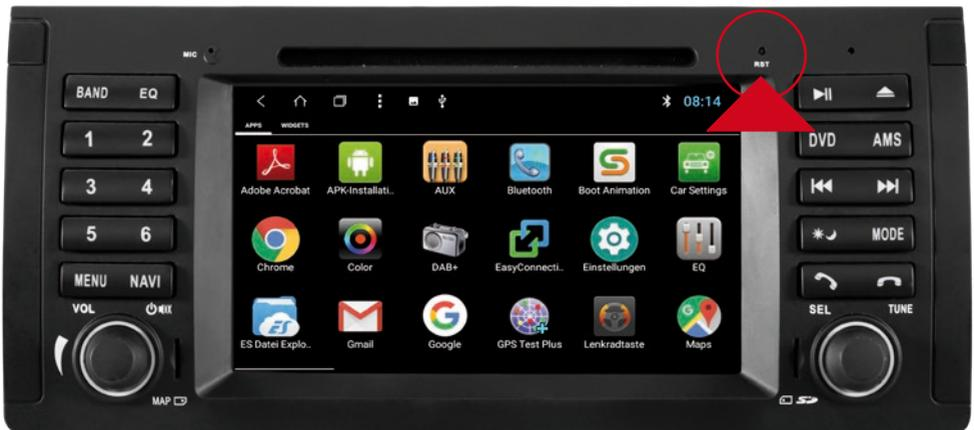
Sollte das Gerät nicht mehr auf Eingaben reagieren, ist das System überlastet oder abgestürzt. Führen Sie dann einen Neustart des Systems durch, indem Sie die Reset-Taste (RST) auf der Frontblende drücken. Verwenden Sie dazu einen geeigneten Gegenstand, wie z.B. eine Briefklammer oder einen Kugelschreiber. Nach Drücken der Reset-Taste startet das System neu, ohne dass Ihre bereits gemachten Einstellungen verloren gehen.
