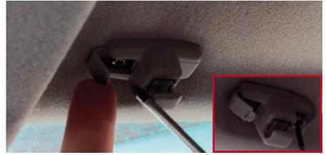
Entfernen Sie die Schrauben der Sonnenblendenhalterung.
