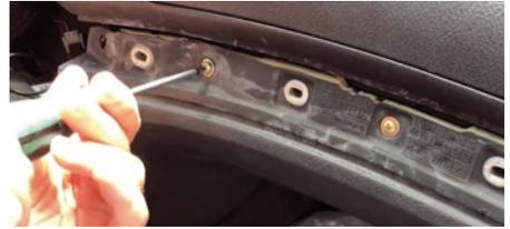
**Befestigen Sie wieder die Schrauben des Armaturenbretts.**
