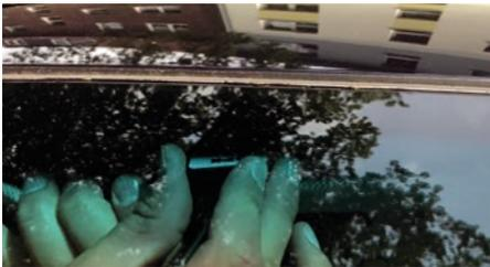
Verstecken Sie die GPS-Antenne hinter dem Dachhimmel, wo zuvor die Sonnenblendenhalterung war.
