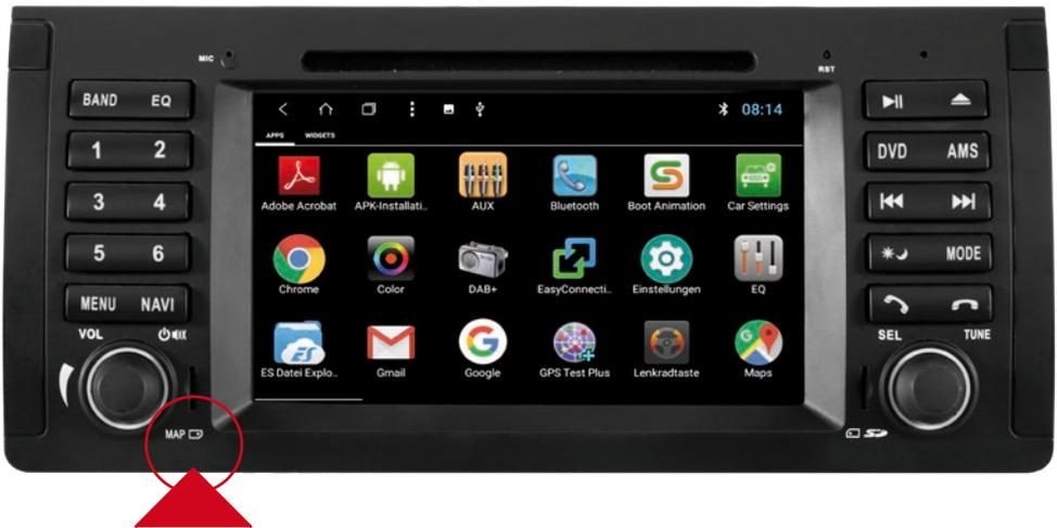
Hier können Sie die MicroSD-Karte der Navigationssoftware einschieben. Damit das Gerät darauf zugreifen kann, müssen Sie eventuell den Zugriffspfad im Menü „Apps“ unter „Einstellungen“ entsprechend zuweisen.
