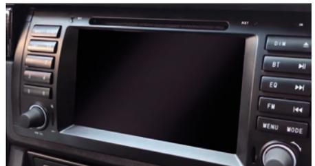
Bringen Sie die Blenden an den oberen Ecken wieder an. Der Einbau ist jetzt abgeschlossen.
