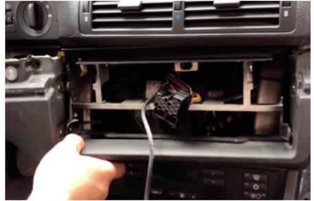
Ziehen Sie den unteren Teil des Armaturenbretts heraus, um die Radiohalterung zu entfernen.
