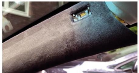
**VORSICHT!** In den A-Säulen der Fahrer- und Beifahrerseite befinden sich die Airbags!
