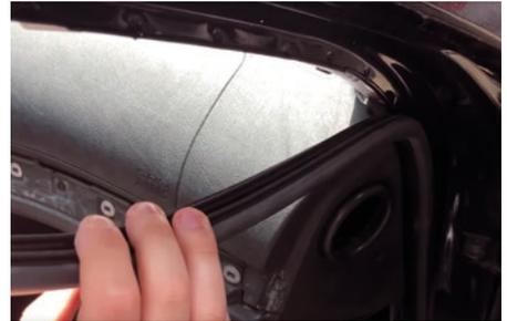
Ziehen Sie die Türdichtung der A-Säule bis zur unteren letzten Schraube ab.
